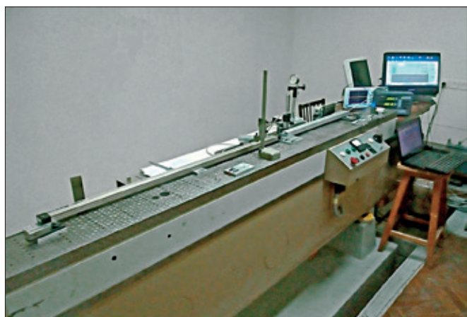
Рис.14. Стенд для проверки датчиков линейного перемещения Fig.14. Stand for verification of linear encoders
